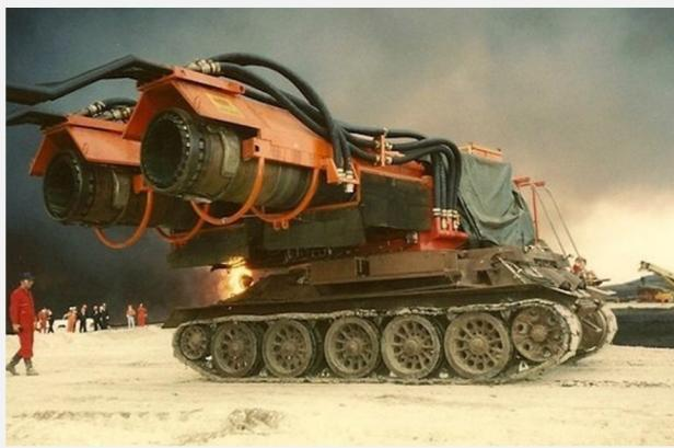
Это не военная разработка злого гения, а эффективный и мощный "огнетушитель", который используется для тушения пожаров на нефтяных и газовых скважинах, когда огромный столб пламени вырывается в небо и потушить его нет никакой возможности. «Огнетушитель» представляет из себя шасси от танка Т-34 с закрепленными на нём двумя двигателями от истребителей МиГ-21.
